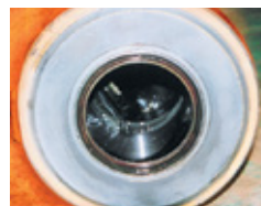
Термическое напыление карбида вольфрама (WC)
